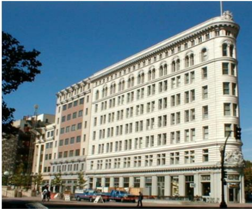
รูปที่ 3 - 13 ตัวอย่างอาคารที่มีความไม่สม่ำเสมอในแนวระนาบซึ่งก่อให้เกิดแรงบิด
